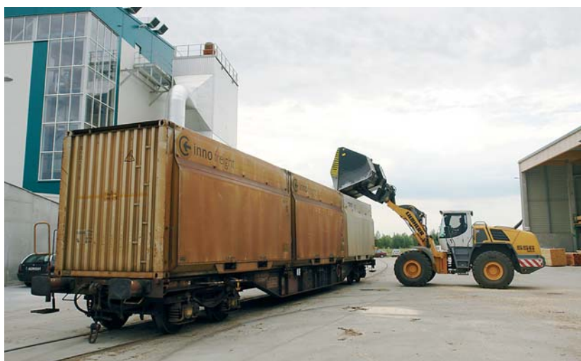
Zkušební nakládka dřevní štěpky do speciálních "woodtainerů" na voze řady Sgnss
