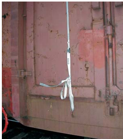
Tkaný textilní popruh s našitou svérkovou přezkou (pohled z jedné strany vozu)
