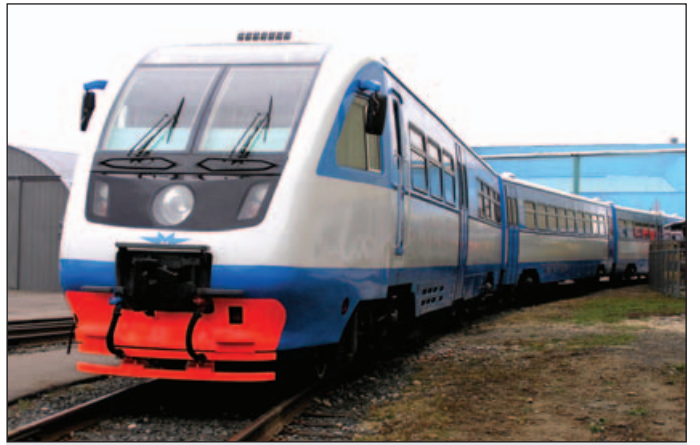
Příměstská doprava byla zastoupena třídičnou motorovou jednotkou RA 2 z produkce společnosti Metrovagonmaš. Foto: AUTOR (6x)
