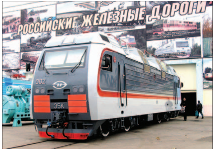
Elektrická lokomotiva E5K je určena na posun a k dopravě lehkých manipulačních vlaků.
