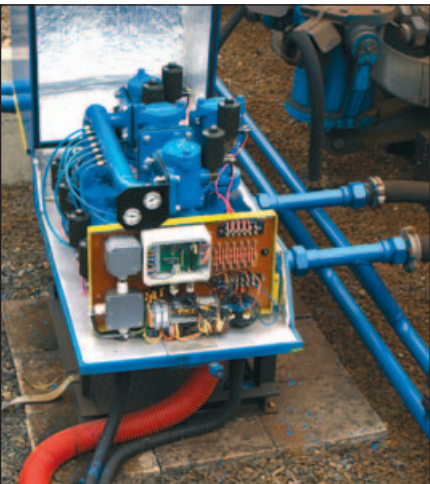
Pneumatické ovládání kolejové brzdy, doplněné regulátorem rychlosti (bílá krabička uprostřed).
