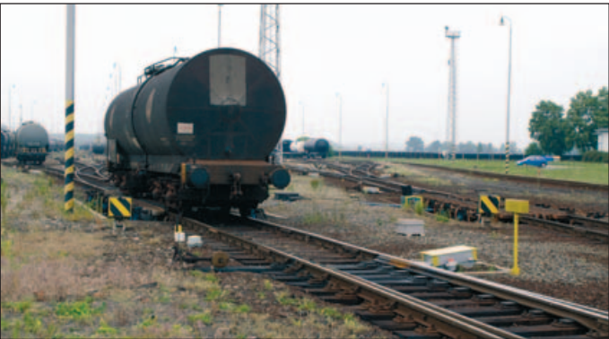
Jedna z brzděných cisteren projíždí kolejovou brzdou, vpravo před brzdou je patrný radarový měřič rychlosti.
