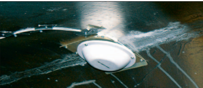
Vnitřní anténa je umístěna zespodu na střeše vagonu.
