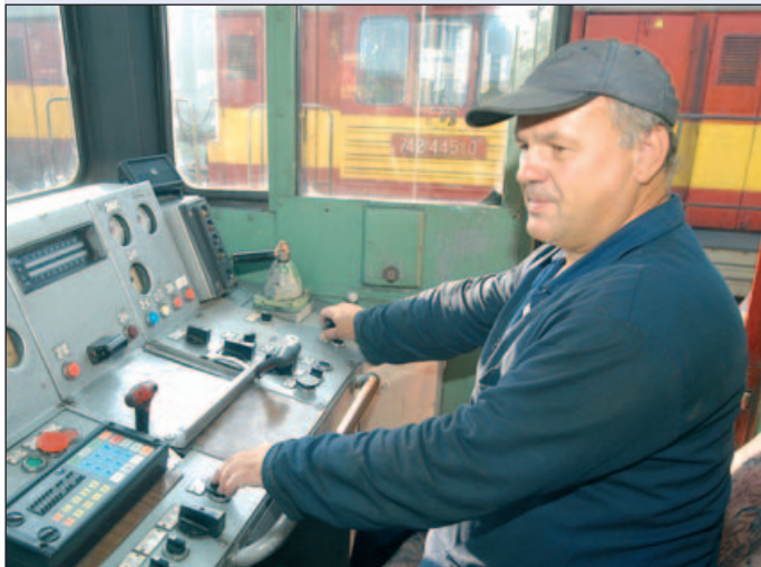
Údržba a zkouška funkčnosti vlakového zabezpečovače probíhá na stanovišti strojvedoucího příslušného kolejového vozidla v simulovaných provozních podmínkách v obvodu PJ Ostrava. Snímek zachytil při ověřování funkcí VZ na lokomotivě 754086-7 elektromechanika Jaroslava Vaňka.
