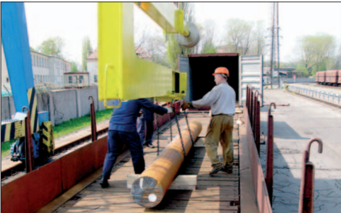
Balancer – speciální přípravek vyvinutý technikou Bonatransu – zvýšil bezpečnost práce i rychlost vykládky a dokonce umožňuje překládku kontisliček přímo na plošinové vozy bez nutnosti mezikladu na ploše areálu.
